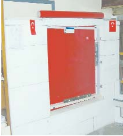
Agpen Dışlı Kör Kasanın Duvara Gönyesinde Montaj Edilmesi ve Duvar Hatalarının Gösteren Laboratuvar Çalışması Örneği
